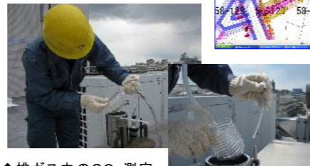
◆排ガス中のSO 3 測定
