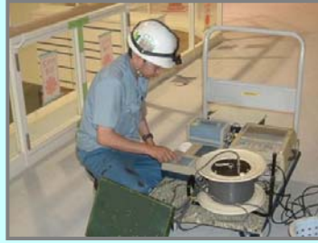
▲レーザー変位計設置状況
