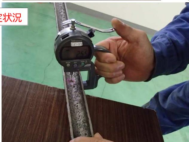
熱交換器にて設備の信頼性を維持し安全運転を図るために、抜管チューブをワイヤレス手動式肉厚測定器で測定し、極値解析システムと組み合わせて測定結果を評価します。
