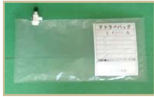
1L バック 0.01ppmまで定量分析 (下水処理場、発生源調査)
