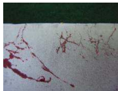
探傷部状況 (PT検査)
