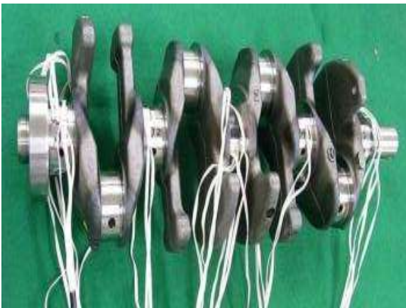
クランクシャフトねじれ・変位測定
