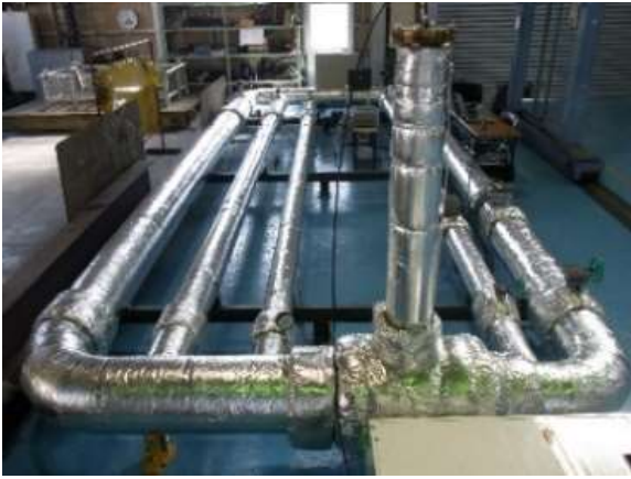
配管圧力損失試験
