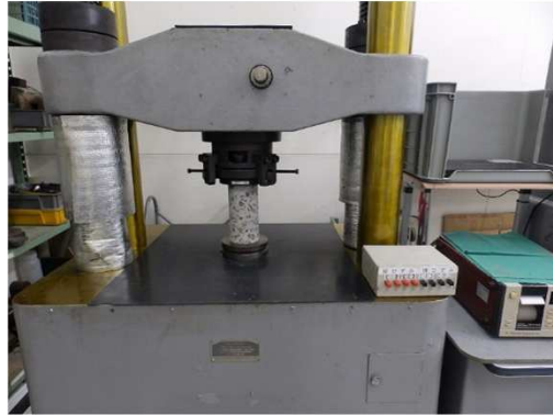
圧縮試験状況（万能試験機）
