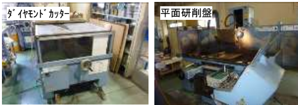
写真-1 CFRP 試験片加工
