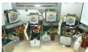
排ガス処理装置性能試験用器材
