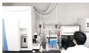
重金属の形態別分析(IC+ICP/MS)
