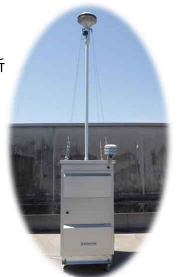
環境大気中の微小粒子状物質 自動計測器
